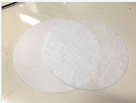
▲ 驻极体-PTFE复合滤料示意图及滤料照片
